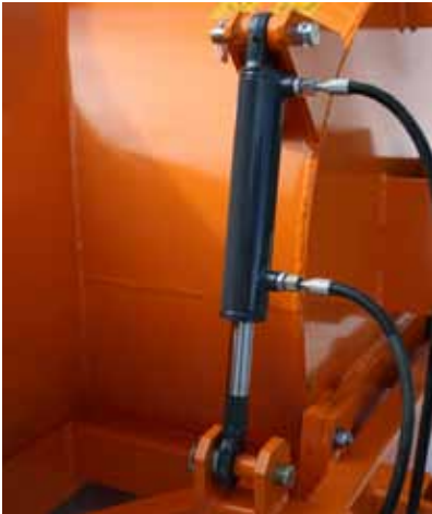
Hydraulische Querneigung der Schneefräse
