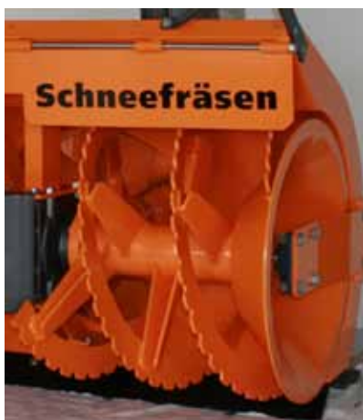
Die schmalen Windungsabstände der Förderschnecken ermöglichen eine hohe Kräfteinsparung bei der Schneezuführung zum Schleuderrad.
