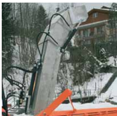
Hydraulisch teleskopierbaren Verlade und Weitwurfkamin (optional)
