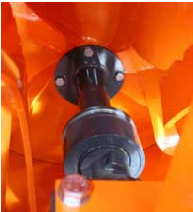
Die Fräshaspeln sind über eine automatisch wiederanlaufende Nockenschaltkupplung abgesichert, die bei grossen Fremdkörpern ausschaltet.
